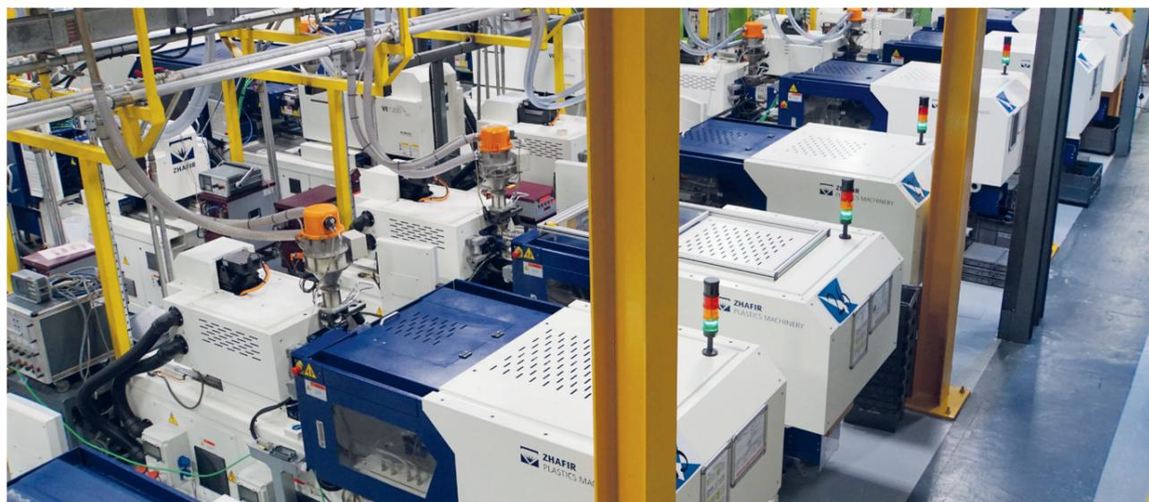
17台具有长飞亚商标的VE电动注塑机，锁模力范围600到1,200 kN。
